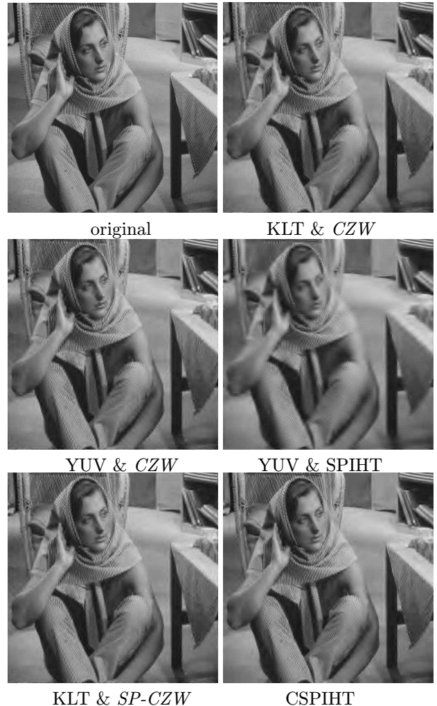
Fig. 2. Performance of KLT & CZW , YUV & CZW , YUV & SPIHT, KLT & SP-CZW , and CSPIHT at 0.25 bpp.
